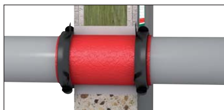
Installation sur mur ou cloison \geq 100 mm avec feuille insonorisante en PE.
