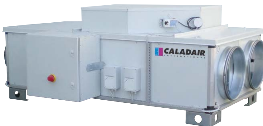
Centrale double flux CDFI avec bypass motorisé et armoire de régulation ELECTROPACK PRO® associée à une ventilation modulante par variateur électronique (VEC) + toiture (TCDF) + pieds (PCB)
