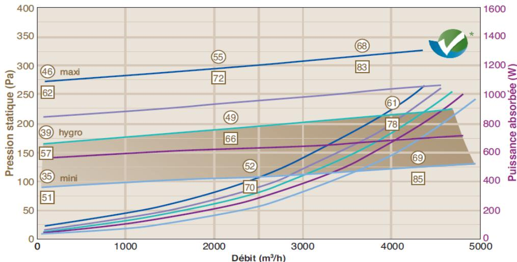
**NOTA :** Les courbes sont réalisées avec un piquage d'aspiration raccordé et rejet caisson non raccordé (configuration C selon la norme NF N 13141-4)
